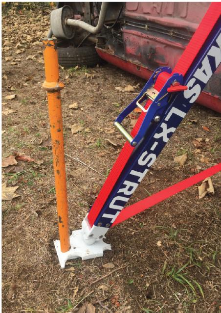
Urządzenie FAP4040 erhältlich bei [www.stabloc.de](http://www.stabloc.de).
